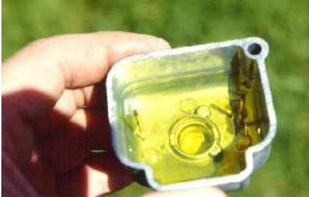
Wasser im Vergaser ist am Boden des Schwimmergehäuses in Form kleiner Perlen sichtbar. Du solltest nicht nur das Wasser aus dem Vergaser entfernen, sondern auch das Wasser aus dem Tank - da liegt normalerweise die Quelle der "Vergaserbewässerung".
