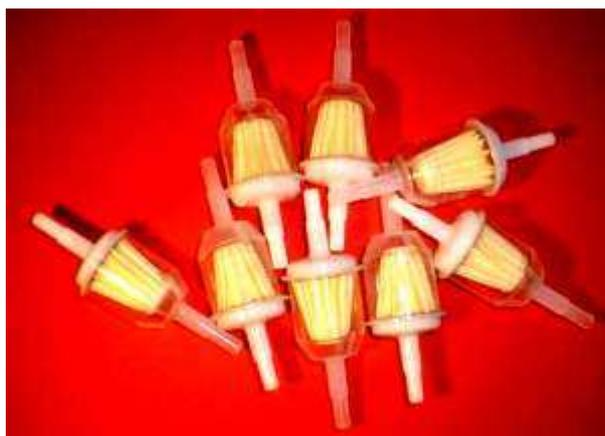
Eine sehr häufige "Vergaserstörung" ist eine mangelhafte Spritversorgung durch fehlerhaften Einbau von Tank, **Filter**, **Brandhahn** oder durch eine defekte **Benzinpumpe**, durch verstopfte oder undichte **Benzinleitungen** (Luftblasen werden angesaugt) oder durch fehlerhafte **Armaturen** oder **Schlauchsellen**. Im Zweifelsfall
